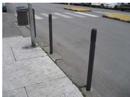
*Esempio di dissuasore di sosta a forma cilindrica*
